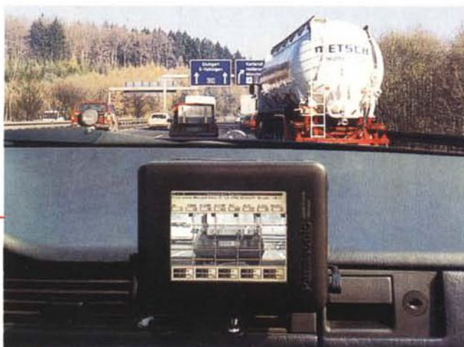
Fig. 6: Gli imponenti risultati ottenuti con VITA II sono frutto di ricerche nel campo della computer vision. Qui vediamo l'analisi della distanza di sicurezza ed il tuning intelligente della velocità di crociera in una situazione di traffico intenso.
